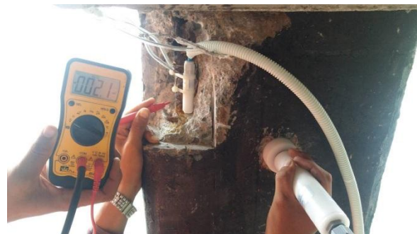
Hình 6 : Điện cực so sánh trong bê tông
