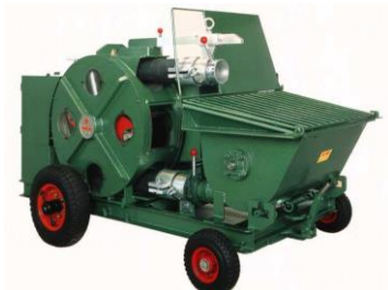
Máy bơm bê tông KAWA KRC-1500
