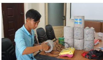
Kiểm tra độ đặc chắc của bê tông phun
