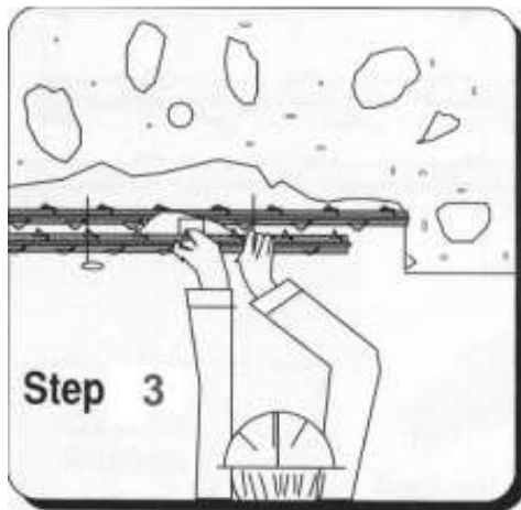
Nối thép bằng phương pháp buộc hoặc hàn
