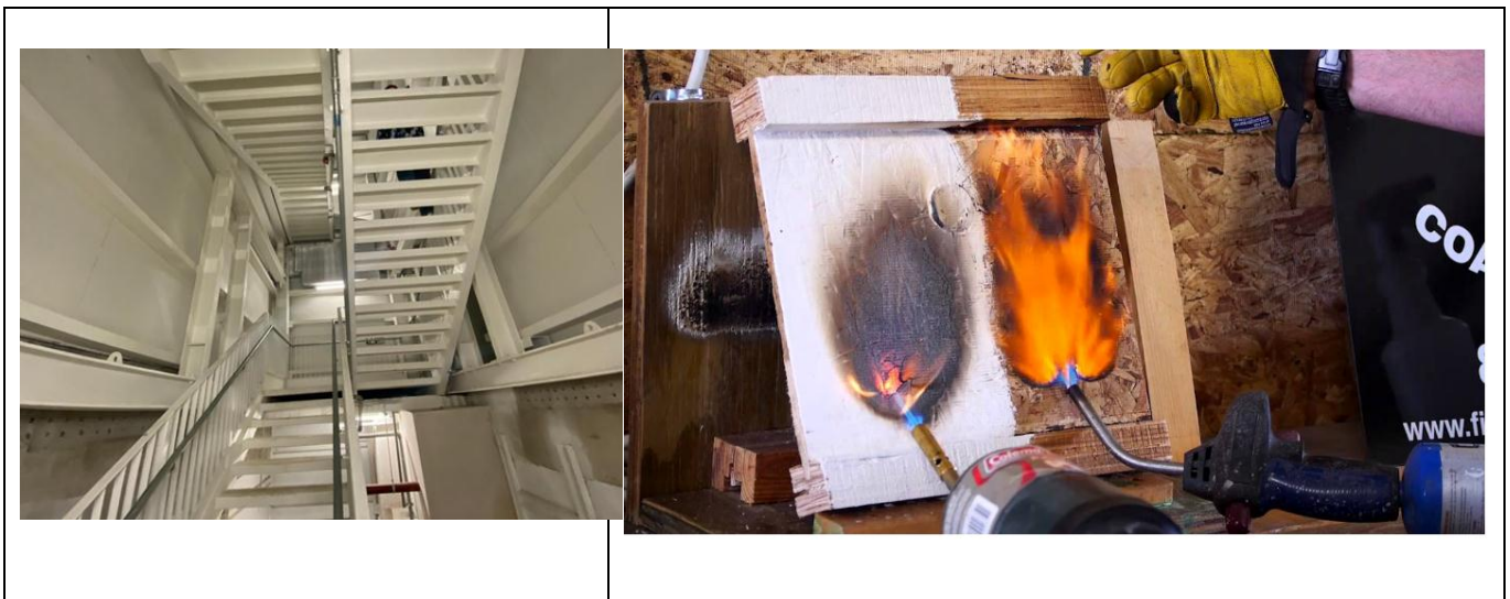
Hình 3: Lớp sơn chống cháy cho cầu thang thoát hiểm
