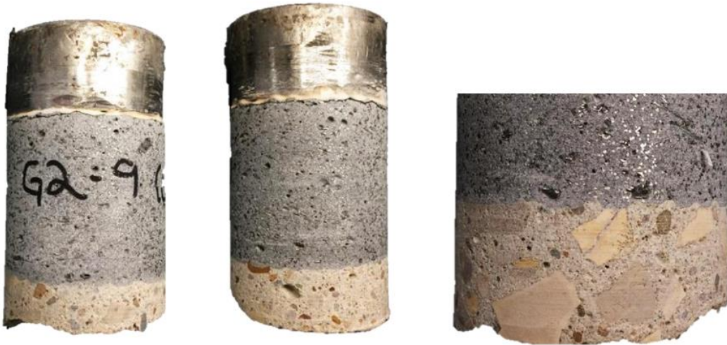
Hình 7: Kết quả kiểm tra độ dính bám giữa lớp bê tông UHPC và bê tông truyền thống
