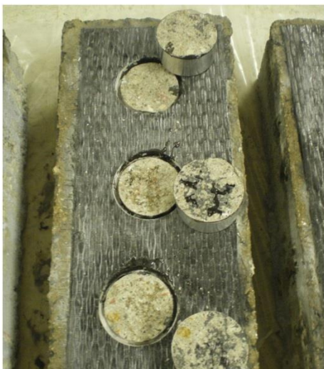
Hình 3 : Thử nghiệm kiểm tra độ bám dính giữa lớp CFRP và bê tông
