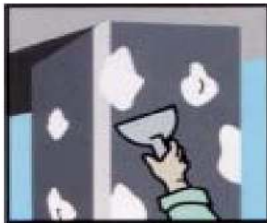
Hình 8 : Trám trét lỗ mọt và tạo phẳng
