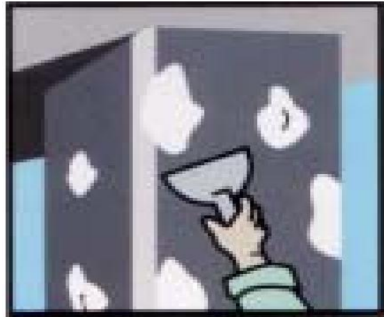
Hình 8 : Trám trét lỗ mọt và tạo phẳng
