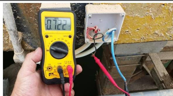
Hình 19 : Hộp nối và kết quả đo điện thế phân cực trong bê tông
