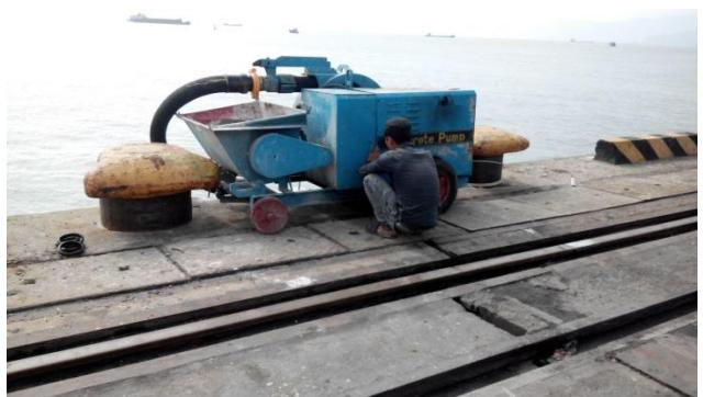
Hình 11A- May bơm bê tông loại vừa
