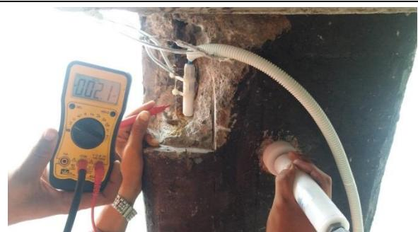
Hình 17: Chôn điện cực so sánh trong bê tông
