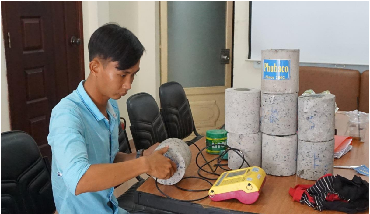
HÌNH ẢNH THÍ NGHIỆM, KIỂM TRA ĐỘ ĐẶC CHẮC CỦA BÊ TÔNG PHUN
