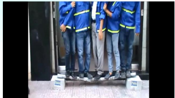
THỬ TẢI THANH BÊ TÔNG GÃY SAU KHI ĐƯỢC DÁN LƯỚI CARBON
