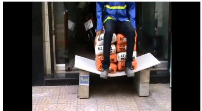
THỬ TẢI TẤM FIBRO XI MĂNG SAU KHI ĐƯỢC DÁN LƯỚI CARBON
